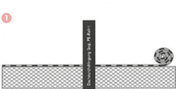
Installer la 1ère couche d'étanchéité. 1. Lage Dichtungsbahn verlegen.
