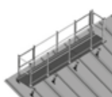
Passerelle sur toiture zinc volige Gehweg auf Zinkdach
