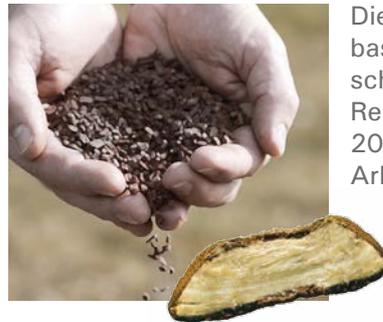
Die einzigartige Lagestabilität basiert auf der definierten kubischen CEMWOOD – Spanform. Realisieren Sie Schütthöhen bis 200 mm rein trocken in einem Arbeitsprozess.
