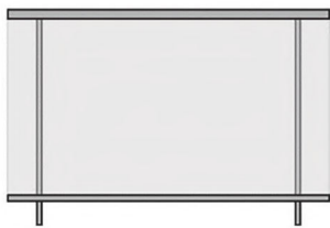
entièrement vitré / Vollverglasung verre clair / translucide / blanc / klarglas / durchschimmernd / Weissglas verre feuilleté 44.2 / Sicherheitsglas 44.2
