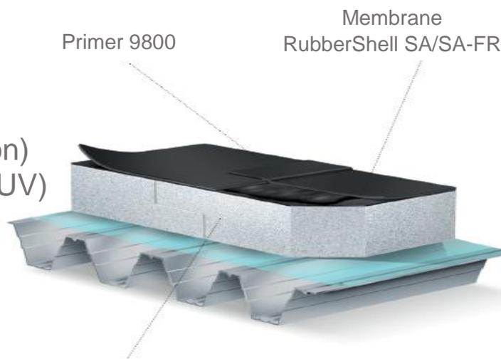
Isolation approuvée. Une couche de séparation peut être nécessaire sur le dessus de l'isolation. Toujours vérifier la compatibilité avec le Primer 9800 avant de coller la membrane.
