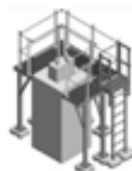
Passerelle sur cheminée Gehweg über dem Schornstein
