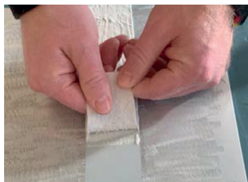
Peler manuellement. L'armature se détache de la couche inférieure du polymère liquide.
