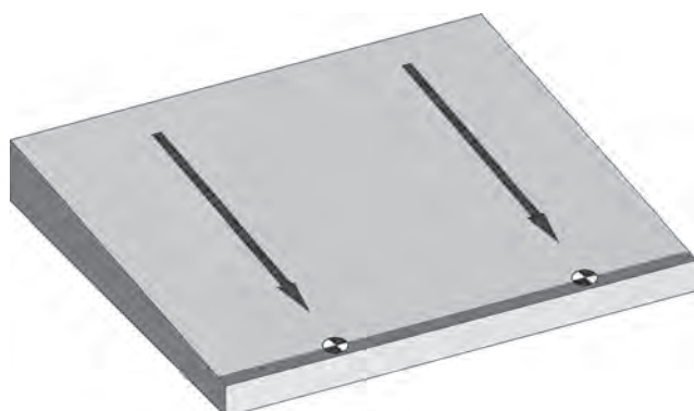
Monopente vers ligne d'eau en bord de toiture Gefälle einseitig - zur Entwässerungszone am Dachrand
